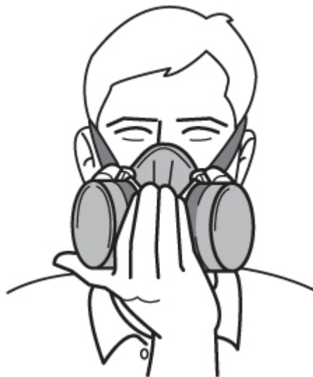
Figure 4 : Vérification de l'étanchéité à la surpression
