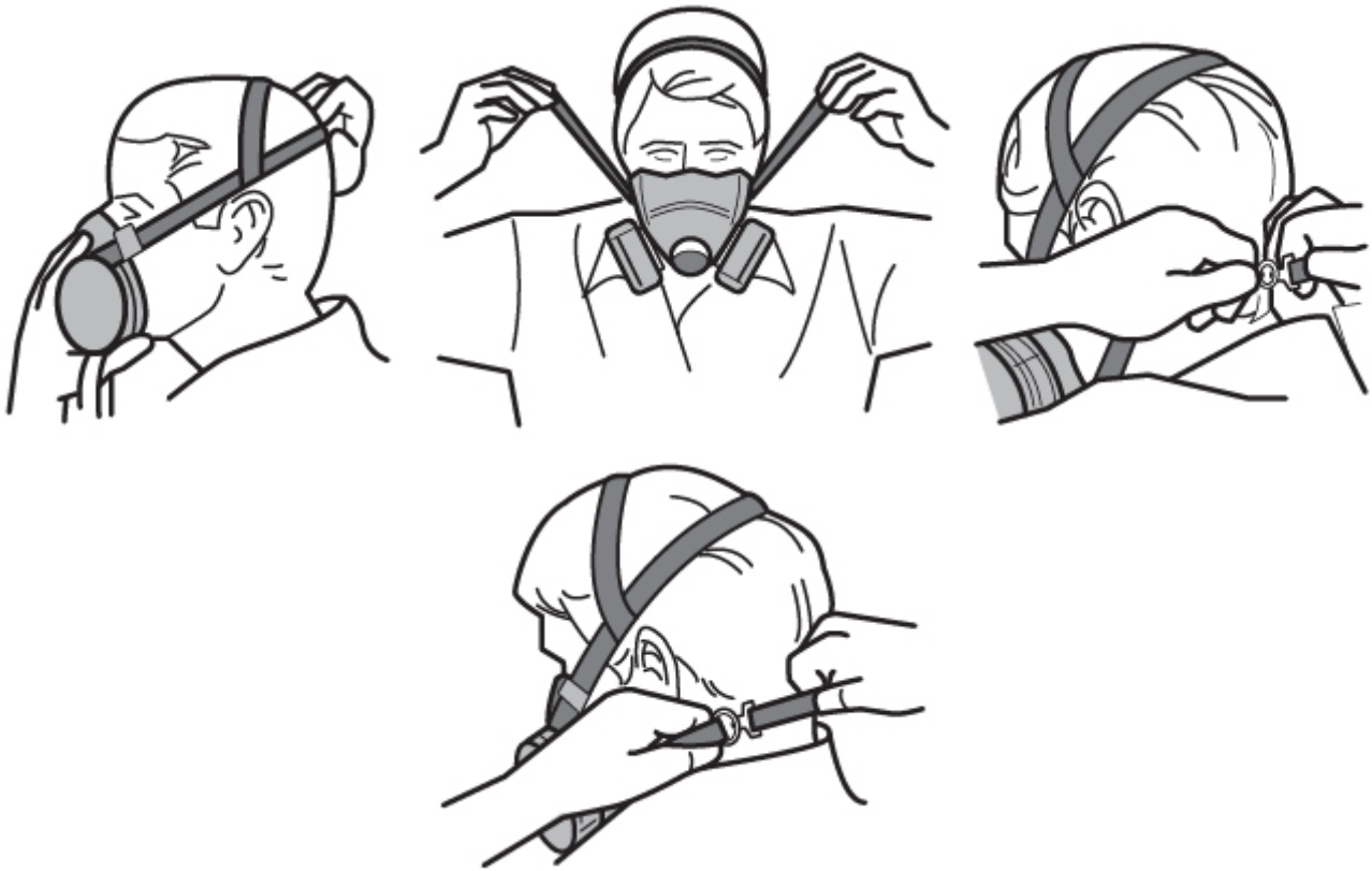
Figure 1 : Procédure pour mettre en place un appareil de protection respiratoire à demi-masque
