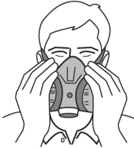
Figure 3 : Vérification de l'étanchéité à la pression à vide
