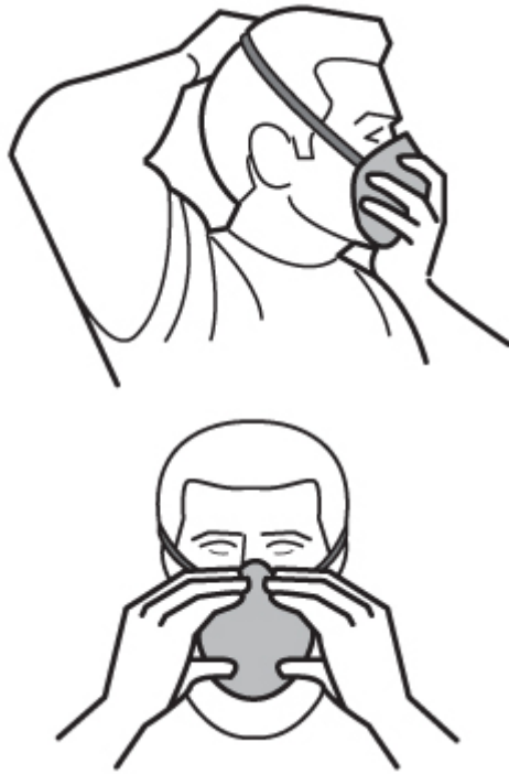
Figure 2 : Mise en place d'un appareil de protection respiratoire jetable
