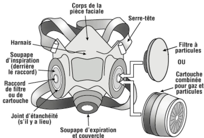
Principaux composants d'un appareil de protection respiratoire à demi masque. On trouve à droite l'illustration de deux options fréquemment utilisées. On utilise le même type de filtres ou de cartouches sur les deux côtés de l'appareil de protection respiratoire.
